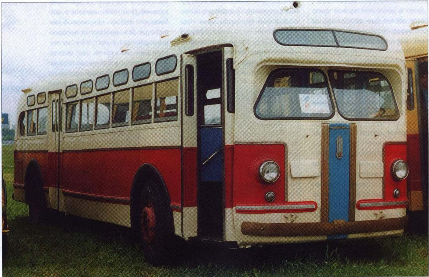
ней был установлен новый шестицилиндровый верхнеклапанный двигатель «БМ-27» мощностью 155 л.с., расположенный в задней части поперек машины. Автобус имел пневматический привод тормозов. Преимущества этих опытных автобусов оказались неоспоримы, но для их выпуска в трудное предвоенное время не было ни ресурсов, ни производственных площадей. Такой же оказалась судьба и автобуса с вагонной компоновкой, разработанного на «ЗИСе», — ЗИС-17 в 1941-м.
