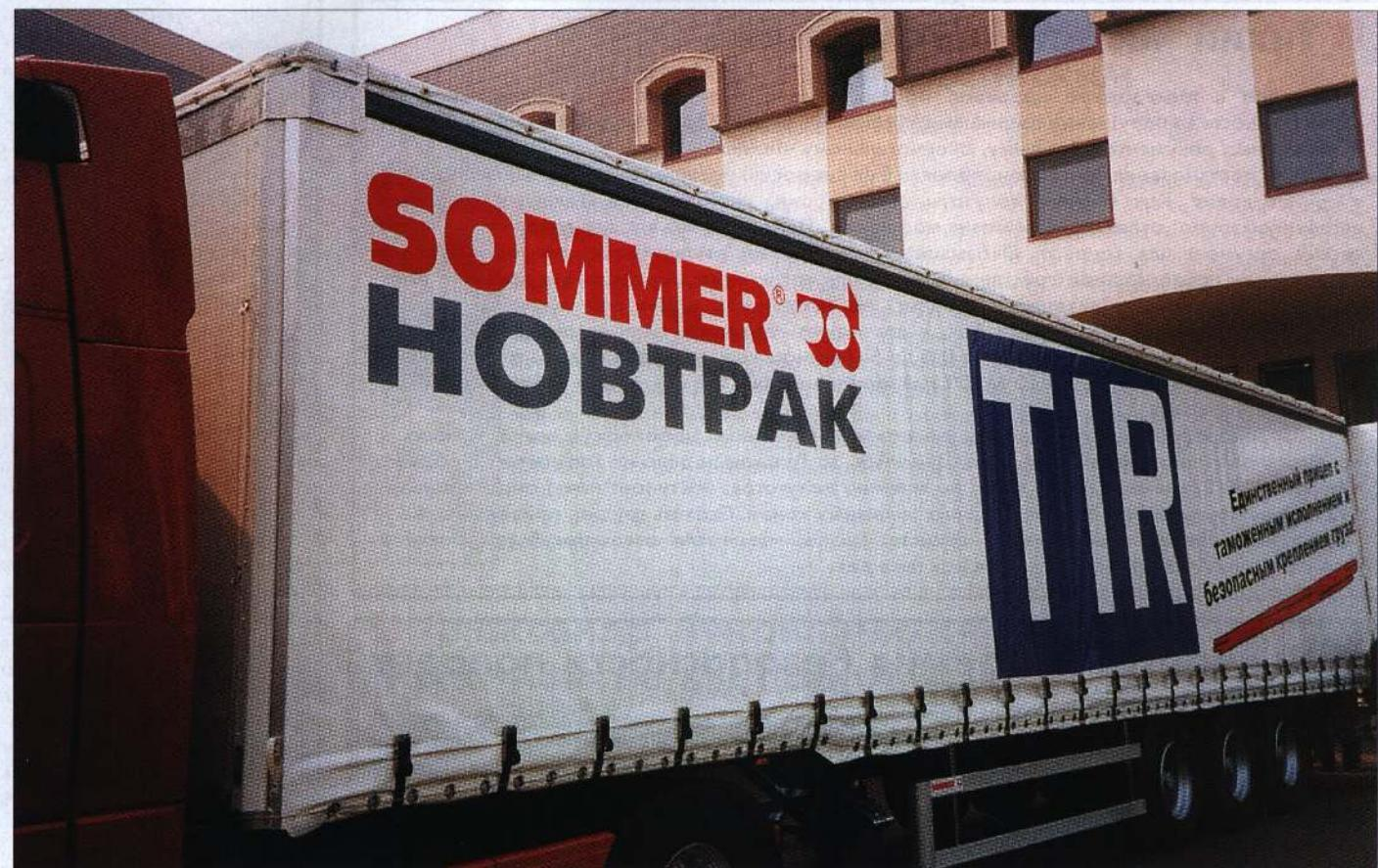
Наибольший интерес вызвал полуприцеп шторного типа, где боковины сдвигаются на роликах вперед или назад по ходу движения независимо от крыши полуприцепа. Именно такие полуприцепы и прицепы наиболее распространены в Европе за счет быстрого и удобного доступа к грузовой зоне. В России прицепы имеют тенты старого образца, когда необходимо сдвигать тент
